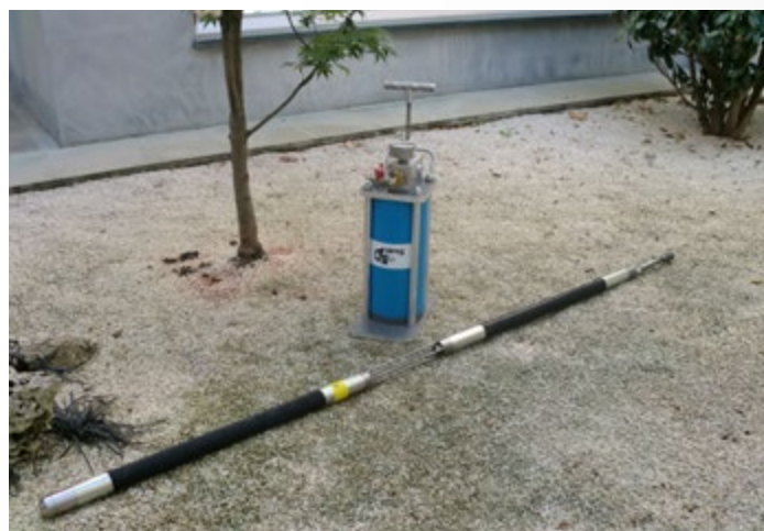
Packer obturateur double gonflable Sireg
